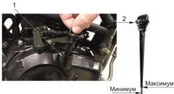
Рисунок 6 – Проверка уровня масла в двигателе
